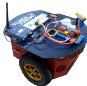
Sl. 2. Pioneer 3DX mobilni robot sa pridruženim sensorima i WiFi adapterom
