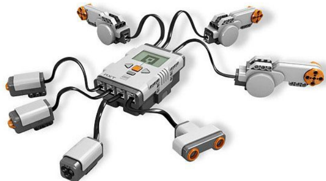
Sl. 4. LEGO Mindstorms NXT 8547 komplet: programabilna jedinica, tri DC motora sa integriranim enkoderima, dva senzora za dodir, sensor za boju ili količinu svetlosti, ultrazvučni sensor rastojanja.
